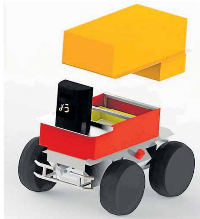
Der automatische Löschroboter soll mit verschiedenen Modulen und Löschmitteln ausgestattet werden können.
